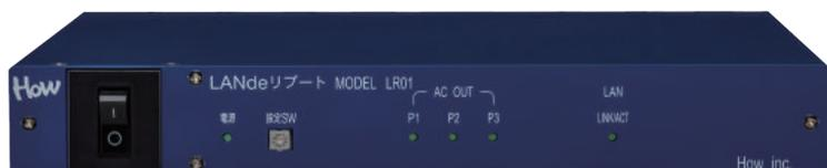
LR01は、ICMPパケットによるIP通信の状態確認(Ping)の応答を利用した通信状態の監視装置です。監視対象機器の未応答が続き異常と判断すると自動で電源出力をOFF/ONしリブートを行います。またネットワーク経由からの手動による電源出力の制御も可能です。
